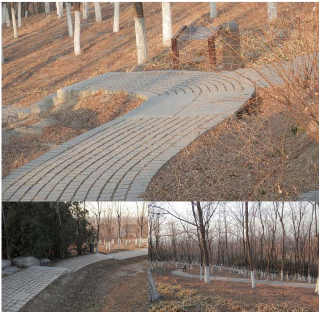
生态林中利用山体坡度进行雨水收集，汇入透水道路两侧的植草沟。
